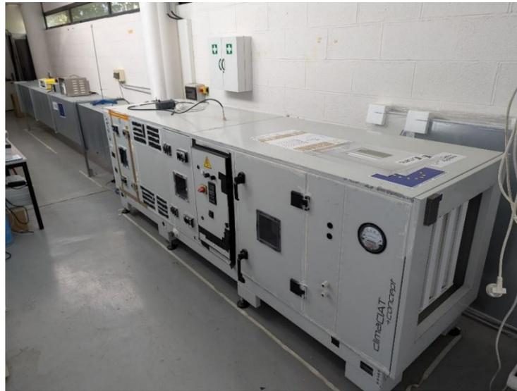
*Banc d'essai du LaSIE pour la mesure de l'efficacité spectrale et de la perte de charge des filtres (crédit : LaSIE / La Rochelle Université)*
