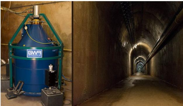
*Figure 1 - Le gravimètre à supraconductivité de Membach se trouve à l'extrémité d'un tunnel de 140 m de long. Ce gravimètre contient une sphère de 4 grammes en lévitation dans un champ magnétique. La supraconductivité du capteur est assurée par l'hélium liquide dont la température avoisine les -269 °C. Photos : E. Coveliers.*
